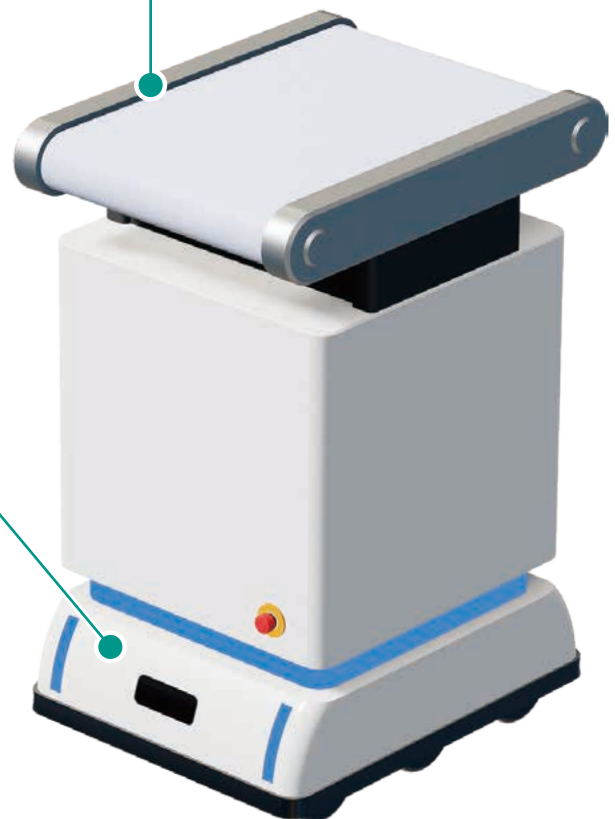
用途例：ベルトコンベヤ付きの自走搬送ロボット
