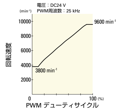
PWMデューティ・回転速度特性例
