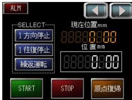
3種類の運転方法が設定されており、画面で選択してから運転を開始します。
