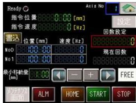
材料に適した運転速度を画面で入力し、運転を開始させます。
