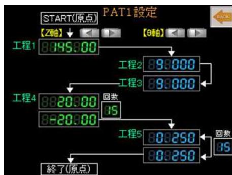
タッチパネルの画面に4工程ごとの加工データを設定させています。ワークが変わるとデータを画面上で変更させます。
