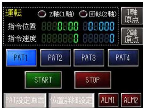
2軸の加工機で4種の部材に対応しています。加工距離はAZドライバに設定され、画面で部材を選んでSTARTボタンで運転が開始されます。
