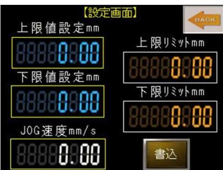
タッチパネルを直接タッチしてリミットとなる数字を入力できる設計です。書き込みボタンでAZドライバにデータを記憶させます。
