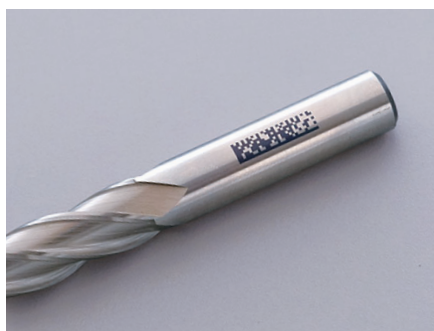
対象ワーク：ハイス鋼工具 印字内容：データマトリックス 印字機種：LM-3250F PC 印字条件：8ns, 1000kHz
