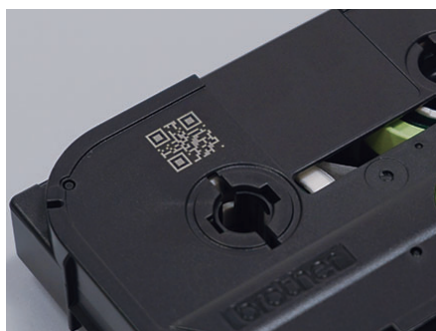
対象ワーク：ABS樹脂カセット 印字内容：QRコード 印字機種：LM-3250F PC 印字条件：8ns, 80kHz
