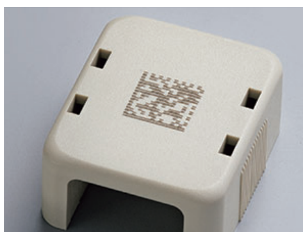
対象ワーク：ABS樹脂 印字内容：データマトリックス 印字機種：LM-3200Fシリーズ
